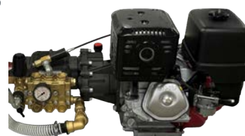
Moteur Honda GX 390 réducté (1560 t/min)
